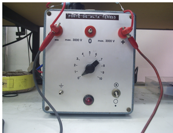
Figura 12 – Gerador de Alta Tensão, Leybold. Fonte: foto do Autor
