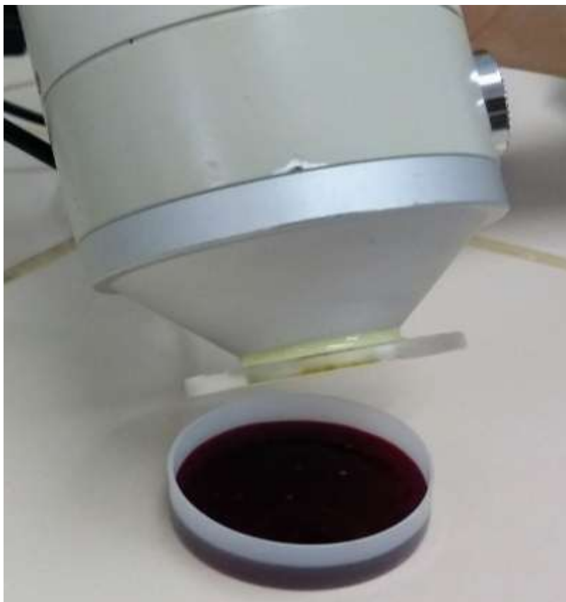
Figura 4: Avaliação de cor utilizando o colorímetro.
