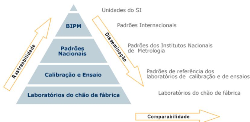
**Figura 5:** Hierarquia metrológica em função da rastreabilidade das medidas (INMETRO, 2006).
