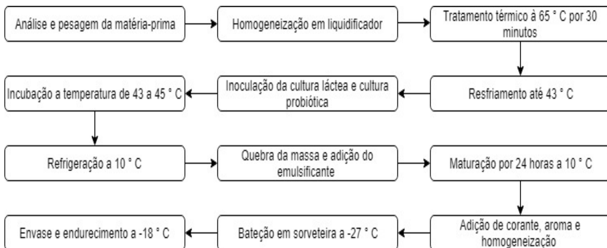
FIGURA 2. Fluxograma de obtenção do frozen iogurte com adição de farinha de batata Yacon, Bifidumbacterium bifidum , edulcorante sucralose acessulfame-k e concentrado protéico do soro de leite. Fonte: Autoria Própria (2018).
