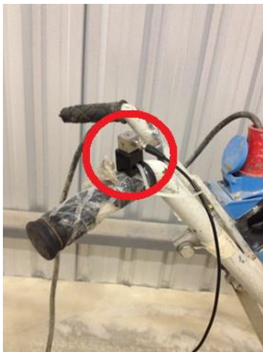
Figura 25 - Acelerômetro posicionado para coleta dos dados Fonte: O autor (2014)
