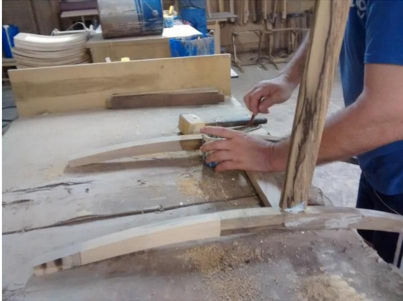
**Figura 14 – União das estruturas traseira e dianteira com cola**
