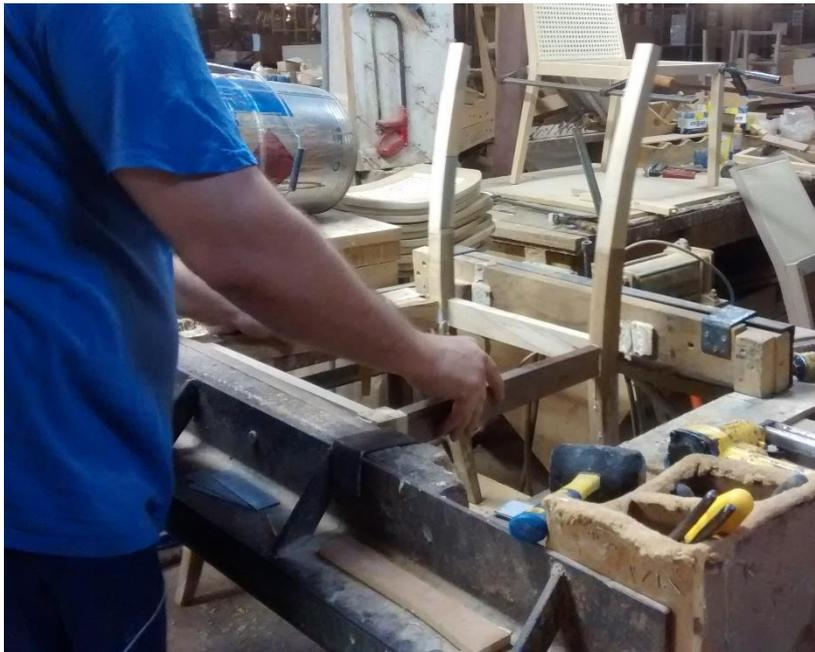
**Figura 15 - União das estruturas traseira e dianteira com prensa pneumática**
