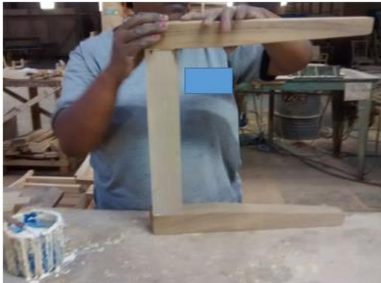
**Figura 9 – Pré-montagem (união com cola)**
