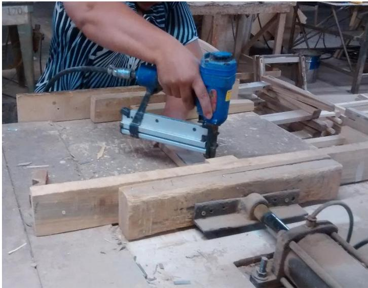
**Figura 11 – Pré-montagem (grampeador)**
