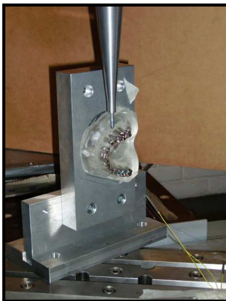
Figura 4.7 Fotografia do modelo maxilar em elastômero com o suporte metálico posicionado para os ensaios de carga.
