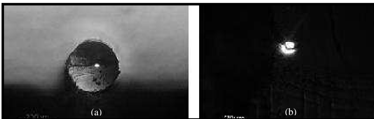
Figura 5.3 (a) Microfotografia da secção transversal da fibra 001, mostrando a luz do núcleo; (b) Microfotografia com maior aumento mostra a luz transmitida através do núcleo.
