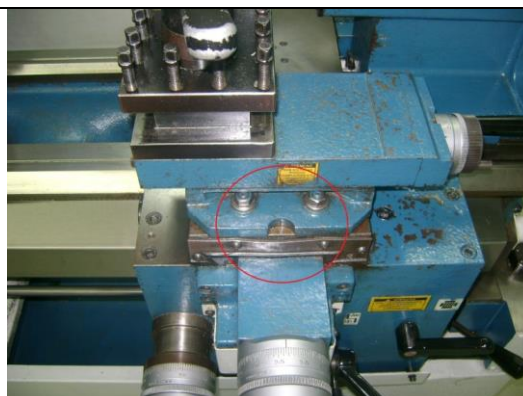
Figura 34 - Fotografia superior dos carros principal, transversal e superior tiradas no SENAI de Marília-SP. Fonte: Autoria própria.
