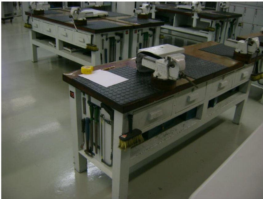
Figura 22 – Fotografia para exemplo de bancada com painel, no SENAI de Marília-SP. Fonte: Autoria própria.
