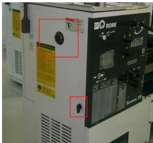
Figura 32 - Fotografia do eixo árvore e porta da caixa de energia do torno, tirada do SENAI de Marília-SP.
