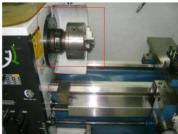
Figura 31 – Fotografia da placa de 3 castanhas e barramentos de torno, tirada do SENAI de Marília-SP.
