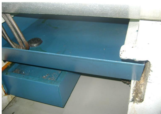
Figura 36 - Fotografia da bacia coletora de cavacos do torno, tirada do SENAI de Marília-SP. Fonte: Autoria própria.
