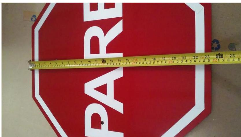
Figura 18 - Dimensão incorreta da placa octogonal de 600mm.
