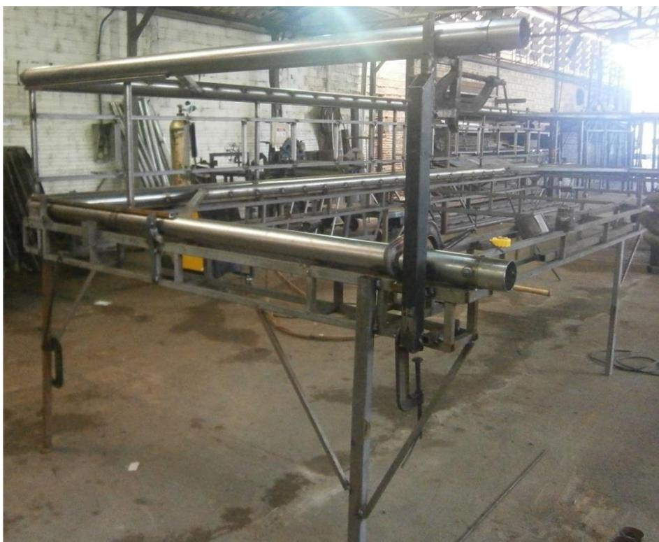
**Figura 20 – Soldagem dos quadros realizada no gabarito.**
