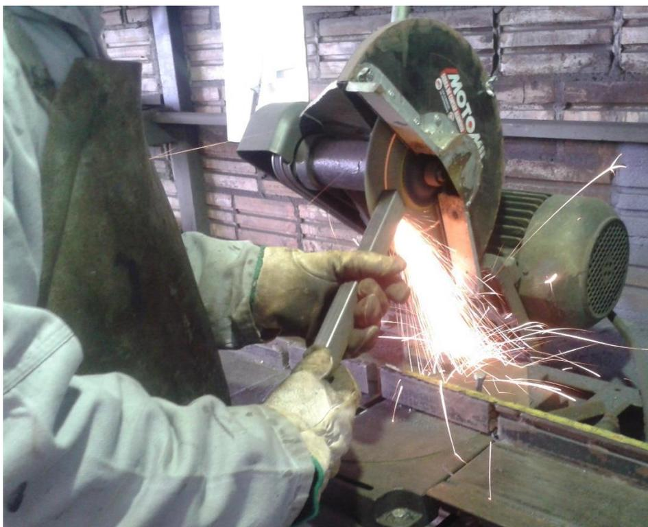
**Figura 18 – Detalhe de execução do corte com equipamento com policorte.
