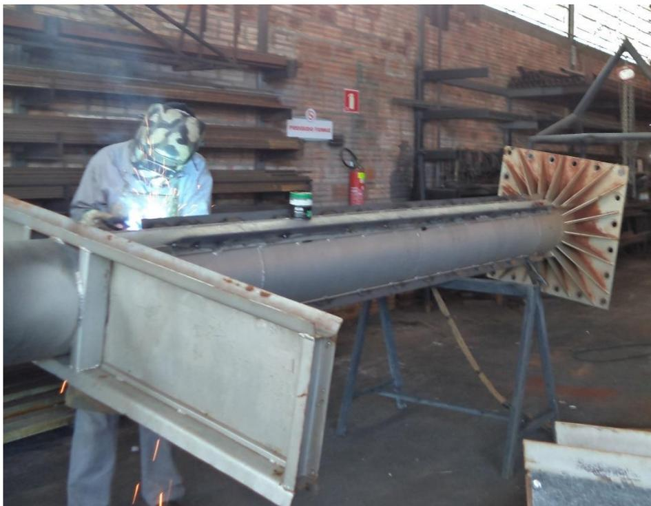
**Figura 22 - Detalhe do processo de soldagem do tubo de sustentação.
