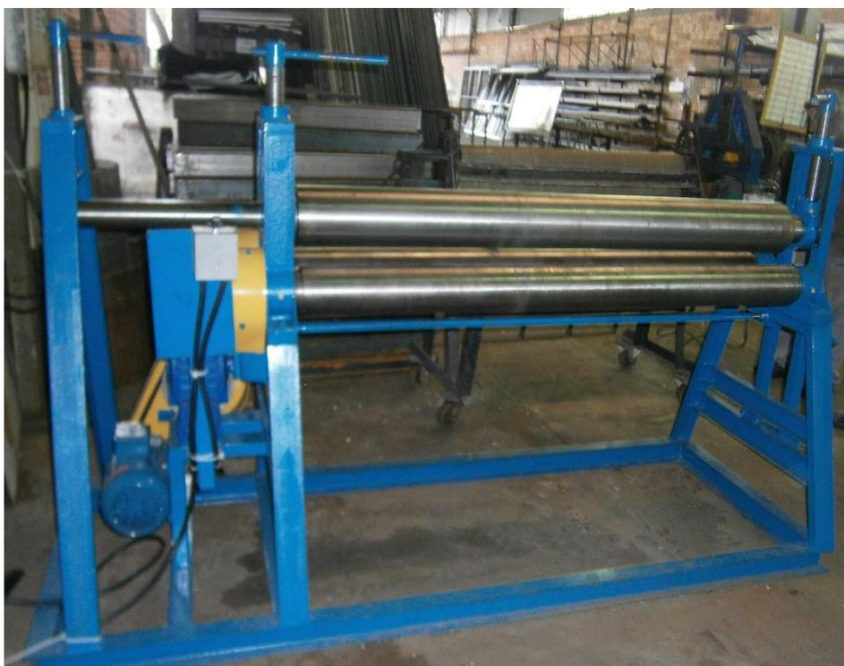
**Figura 21 – Calandra para a moldagem dos tubos.
