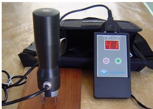
Figura 14 - Medidor elétrico baseado em medidas de resistência Fonte: Digisystem (2013).
