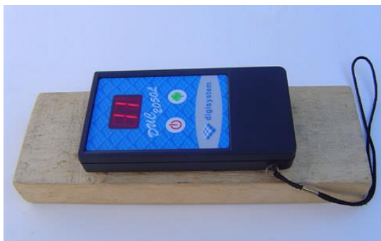
Figura 15 - Medidor elétrico baseado na resistência da capacidade elétrica Fonte: Digisystem (2013).
