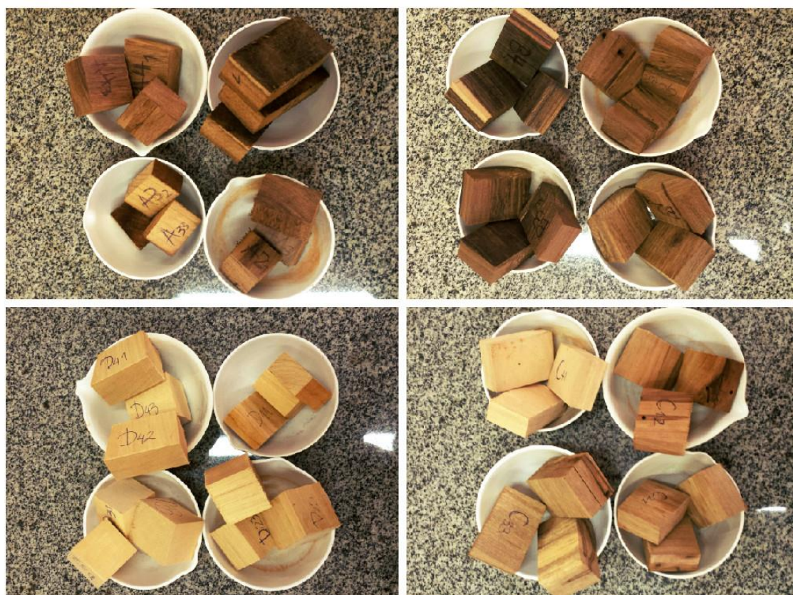
Figura 16 - Amostras das madeiras em triplicata: na parte superior esquerda Canela (A) e na direita Guajuvira (B); parte inferior direita Açoita-Cavalo (C) e na esquerda Pau-Marfim (D). Fonte: AUTOR, (2015).
