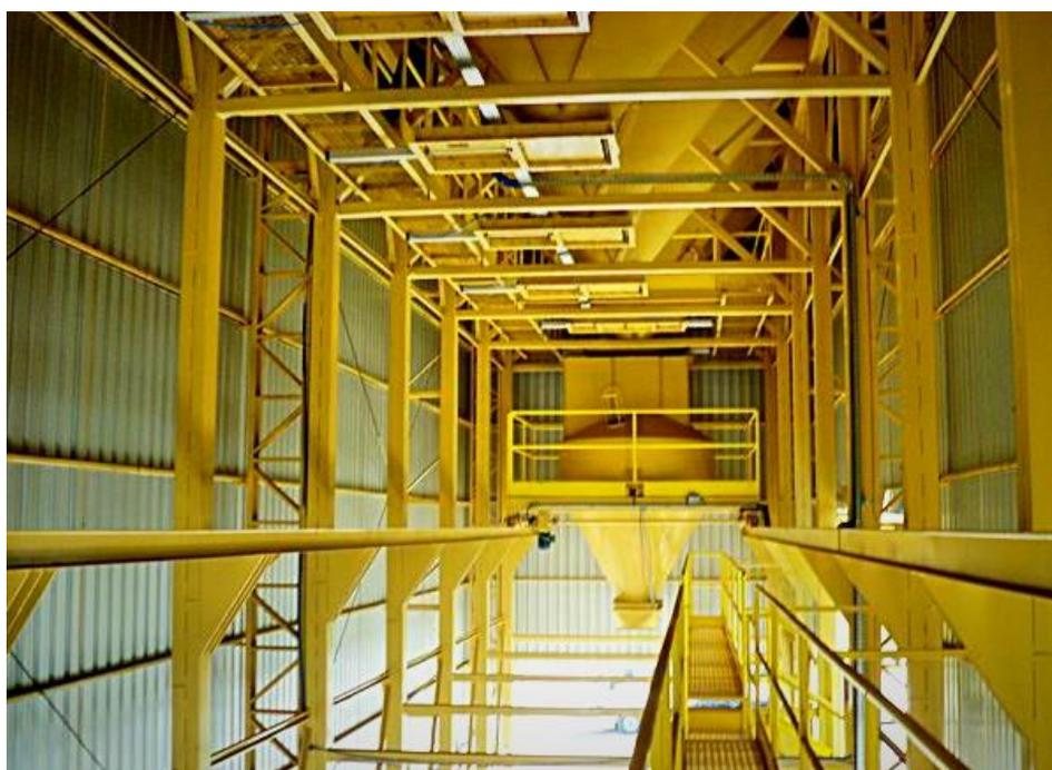
**Figura 18 - Balança automática operando em linha de carregamento**
