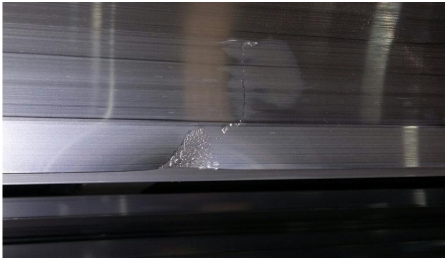
Figura 25 - Amassamento do perfil (b). Fonte: O autor.
