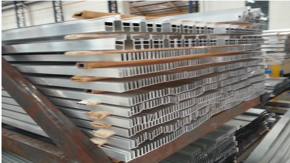
Figura 20 - Acomodação dos perfis no cesto (b). Fonte: O autor.
