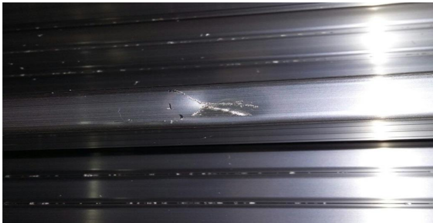
Figura 26 - Amassamento do perfil (c). Fonte: O Autor.
