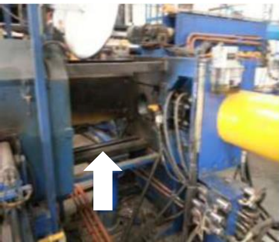
Figura 15 - Corte do tarugo (a) e início da extrusão (b) Fonte: O autor.
