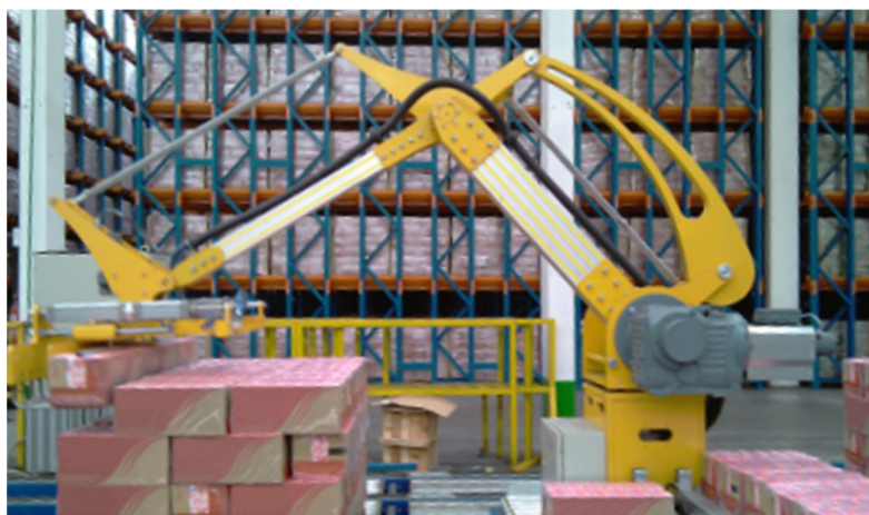
Figura 15 – Robô paletizador – Marca Magnoflux, Modelo P160i Fonte: Site Magnoflux (2011)
