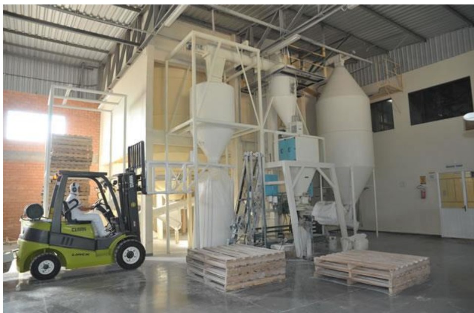
Figura 5–Sistema atual de mistura e ensaque de farinha de trigo. Fonte: Autoria própria.
