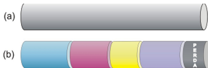
Figura 3- (a) Objeto (barra) a ser cortado; (b) Padrão de corte produzindo 4 itens e uma perda Fonte: CHERRI (2009)
