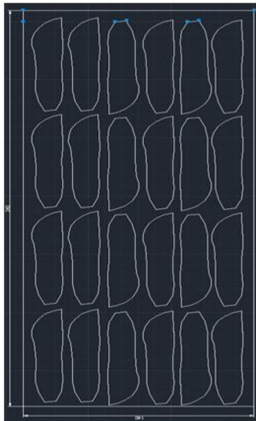
Figura 16- Modelo de banco soft largo normal 103 com tecido courvin utilizado na lateral do encosto, baseado na colocação de moldes pela indústria Fonte: Autora, 2013.
