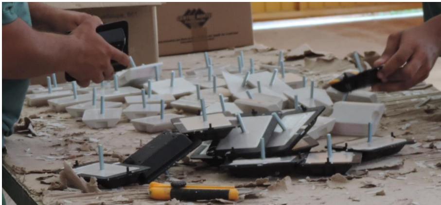
Figura 13 – Desenformar tachas. Fonte: Autoria própria
