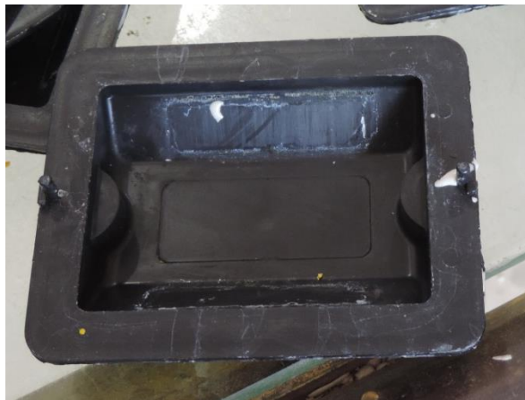
Figura 7 - Forma da tacha Fonte: Autorial própria
