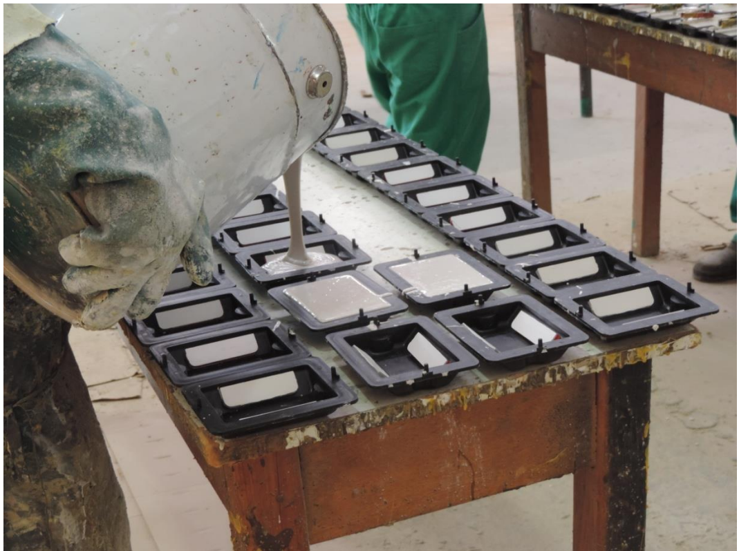
Figura 11 – Preenchimento das formas. Fonte: Autoria própria
