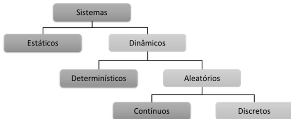
Figura 2 – Classificação dos sistemas para fins de modelagem. Fonte: Adaptado de Freitas Filho (2008)
