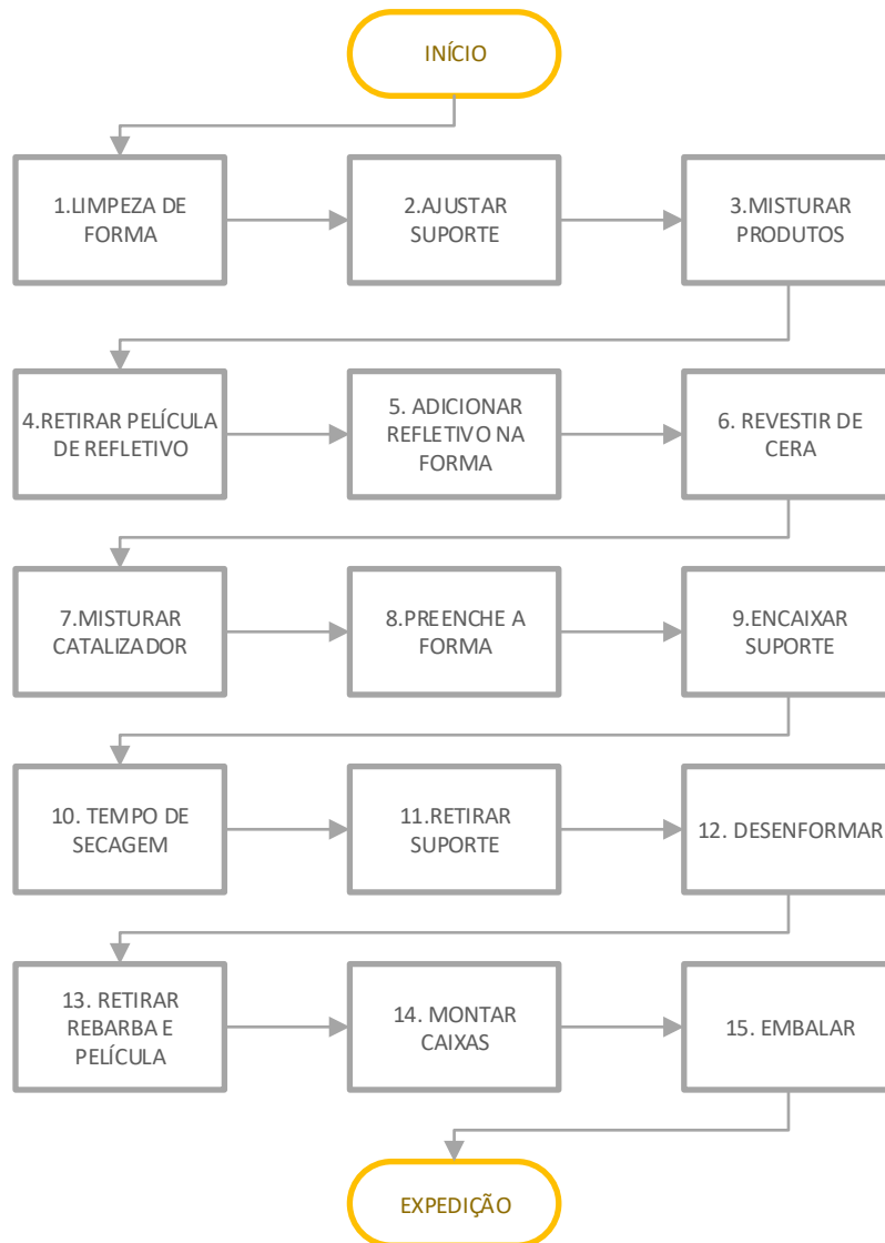
Figura 14 - Fluxograma do processo de fabricação de tachas. Fonte: Autoria própria
