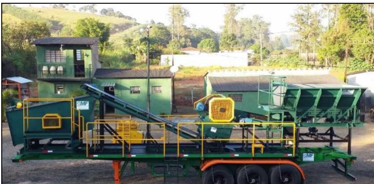
Figura 14. Usina de Britagem Móvel.
