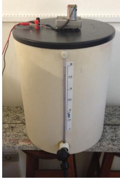
Figura 10 - Barrilete para agitação do coagulante natural de Moringa oleífera
