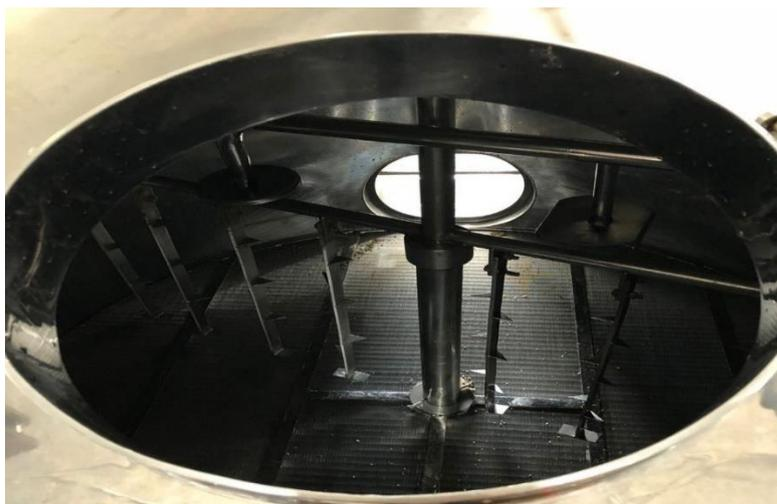
**Figura 7: Tanque para filtração do mosto**
