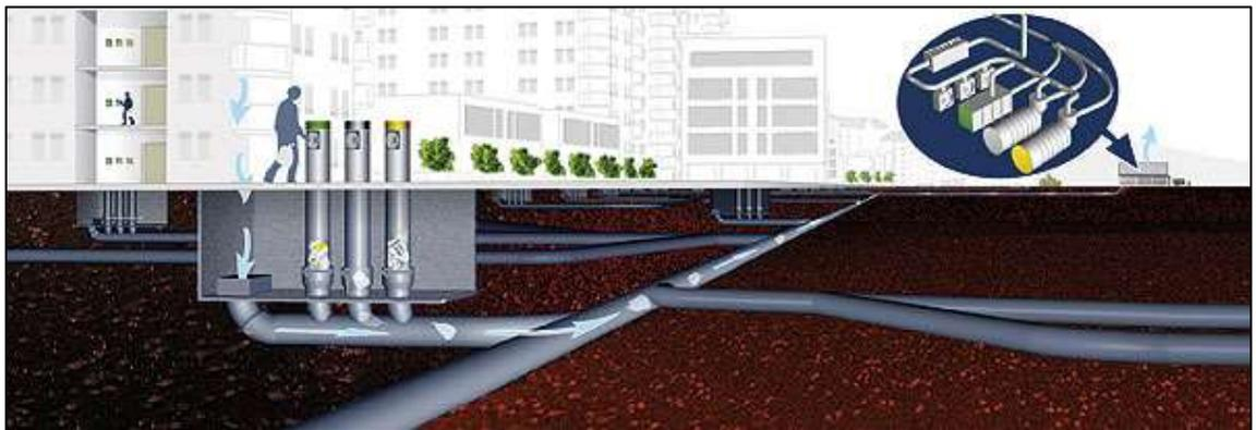
Figura 2- Estrutura de tubulação pneumática de resíduos.
