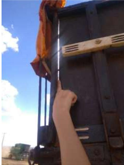
Figura 12- Veículo usado no transporte de grãos com frestas
