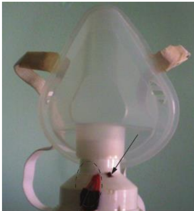
Figura 24 – Máscara contendo os sensores de temperatura. Foram acoplados dois sensores na máscara, um externamente e outro internamente. Estão destacados pela seta e o círculo na figura.
