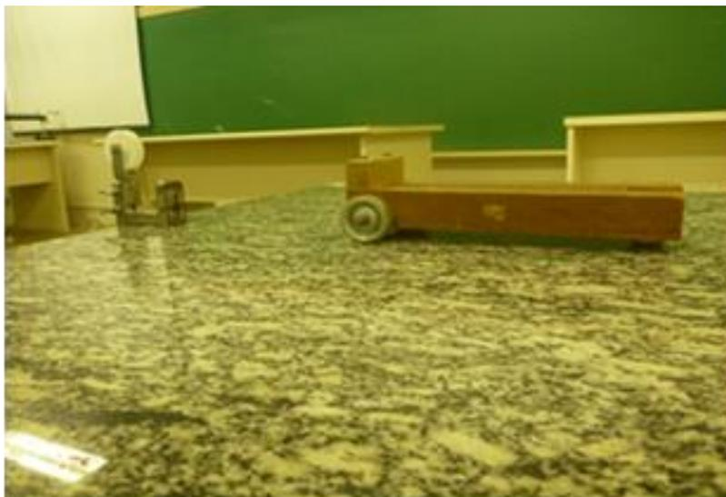
Fotografia 6: carrinho do conjunto do IBEC, alinhado com a proposta do PSSC, para realização da parte artesanal da experimentação da 2ª lei de Newton. Fonte: MUCHENSKI, J. C., 2013.
