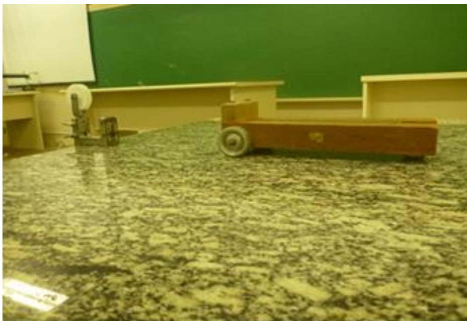
Fotografia 7: carrinho do conjunto do IBEC, alinhado com a proposta do PSSC, para realização da parte artesanal da experimentação da 2ª lei de Newton. Fonte: MUCHENSKI, J. C., 2013.
