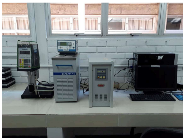
Figura 4 – Viscosímetro rotacional de cilíndricos concêntricos utilizado para determinar as propriedades reológicas das suspensões das blackberries reidratadas em água a 29 °C por 45 minutos.
