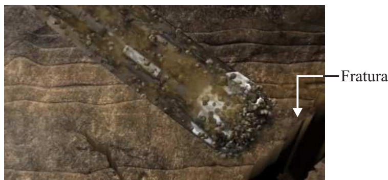
Figura 1.1 – Momento do encontro da broca com uma fratura Fonte: adaptado de Halliburton (2014)
