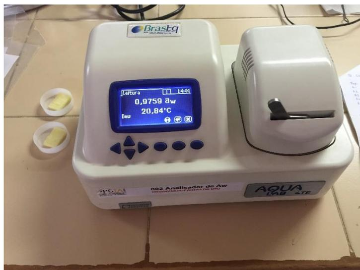
Figura 5 – Determinação da atividade de água nas amostras. Fonte: autoria própria.
