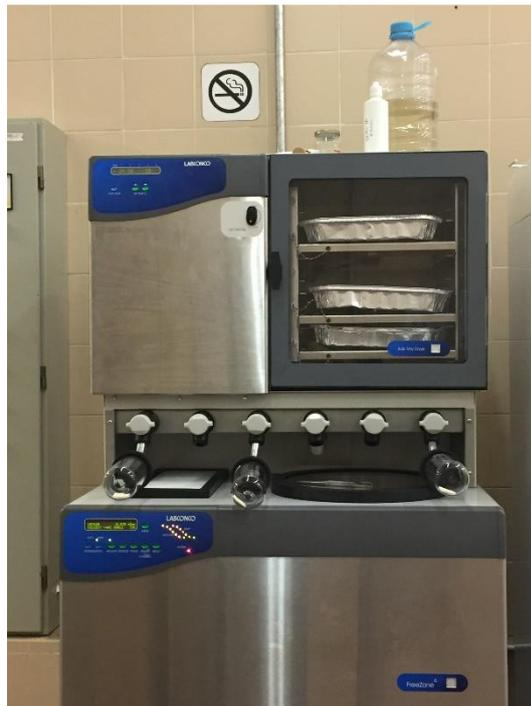
Figura 3 – Liofilizador Labconco utilizado para a liofilização das maçãs. Fonte: autoria própria.
