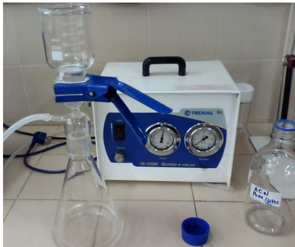
Figura 5. Filtração das soluções usadas na fase móvel.
