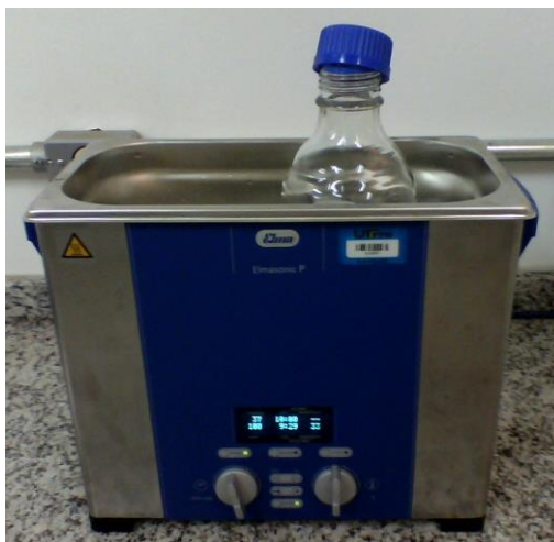
Figura 6. Desgaseificação das amostras no banho de ultra-som.
