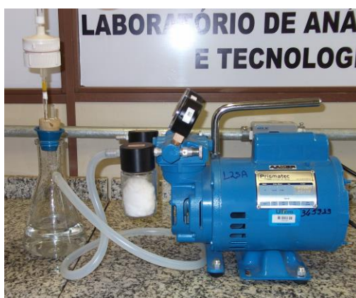
Figura 3. Sistema para pré-concentração dos pesticidas presentes em água subterrânea por extração em fase sólida.
