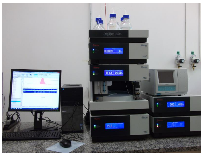
Figura 22. Cromatógrafo de ultraeficiência (UHPLC) utilizado para a determinação de pesticidas.
