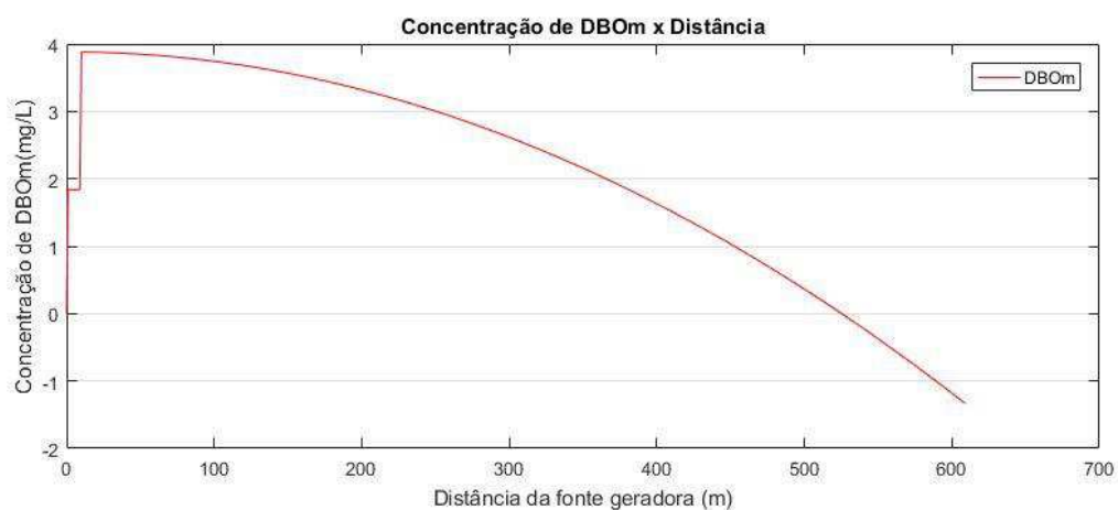
Figura 14: Concentração de DBOm x Distância (menor índice de precipitação)
