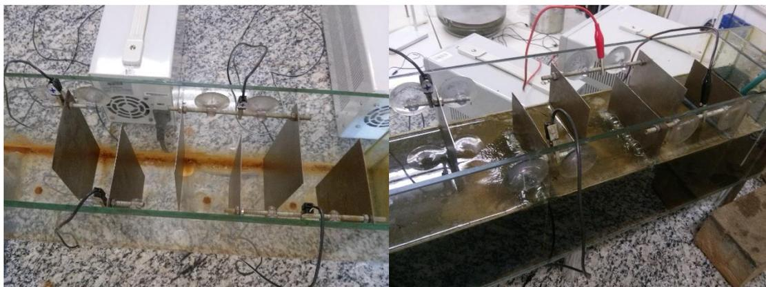
**Figura 4. Disposição dos eletrodos no módulo de fluxo contínuo**
