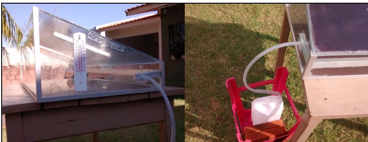
Figura 04: Detalhe do sistema de coleta do destilado e termômetro utilizado
