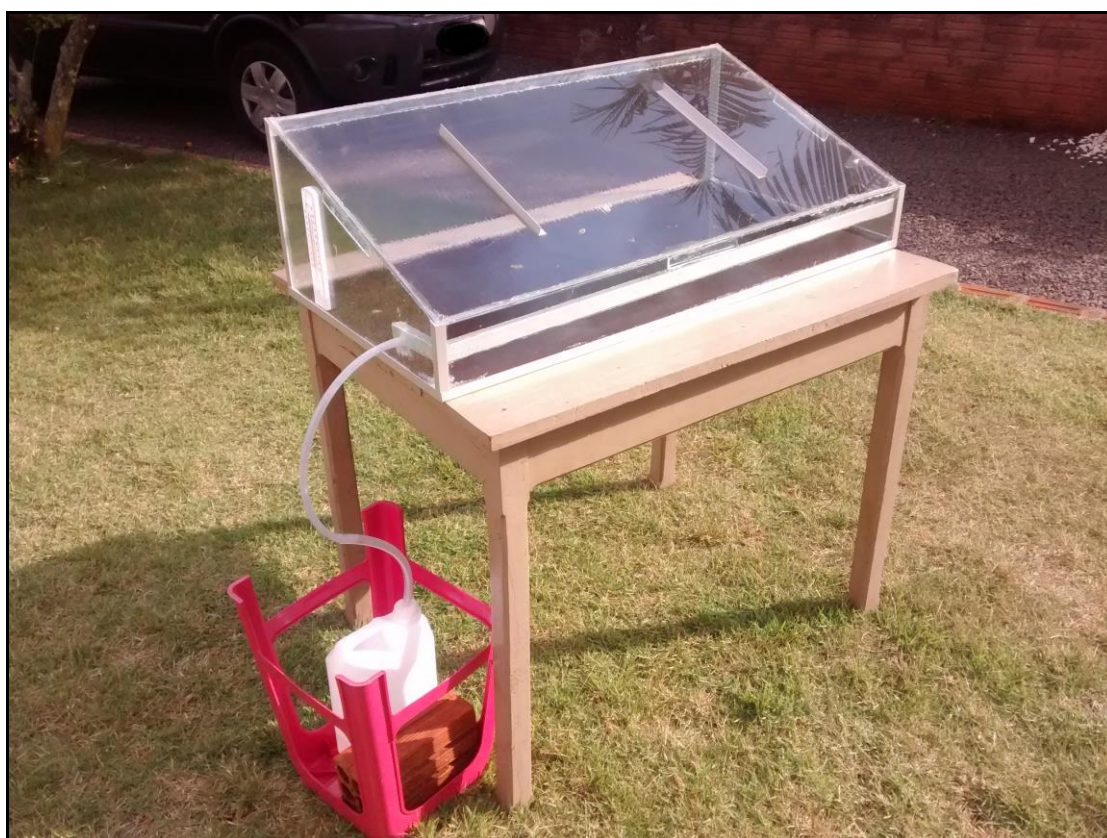
Figura 03: Destilador solar utilizado nos ensaios.
