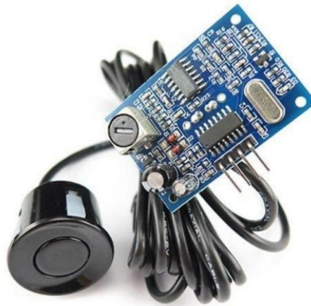
Figura 4: Sensor ultrassônico a prova d'água JSN-SR04T V2. Fonte: AutoCore Robótica, 2019.
