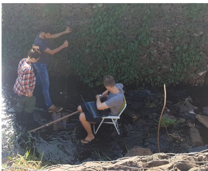
Figura 11: Obtenção da velocidade pelo micromolinete hidrológico no ponto 2 no Rio Alegria.
