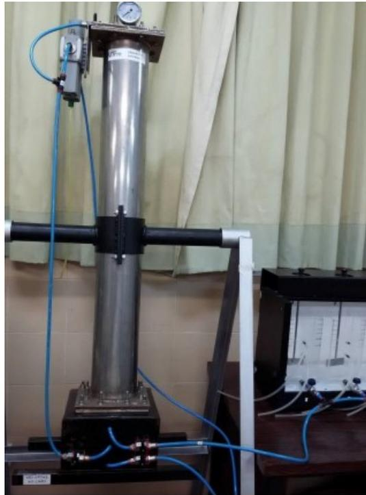
**Figura 10. Câmara de saturação**
