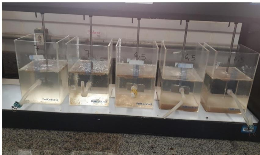
**Figura 16. Efluente em Floculação – Sedimentação**
