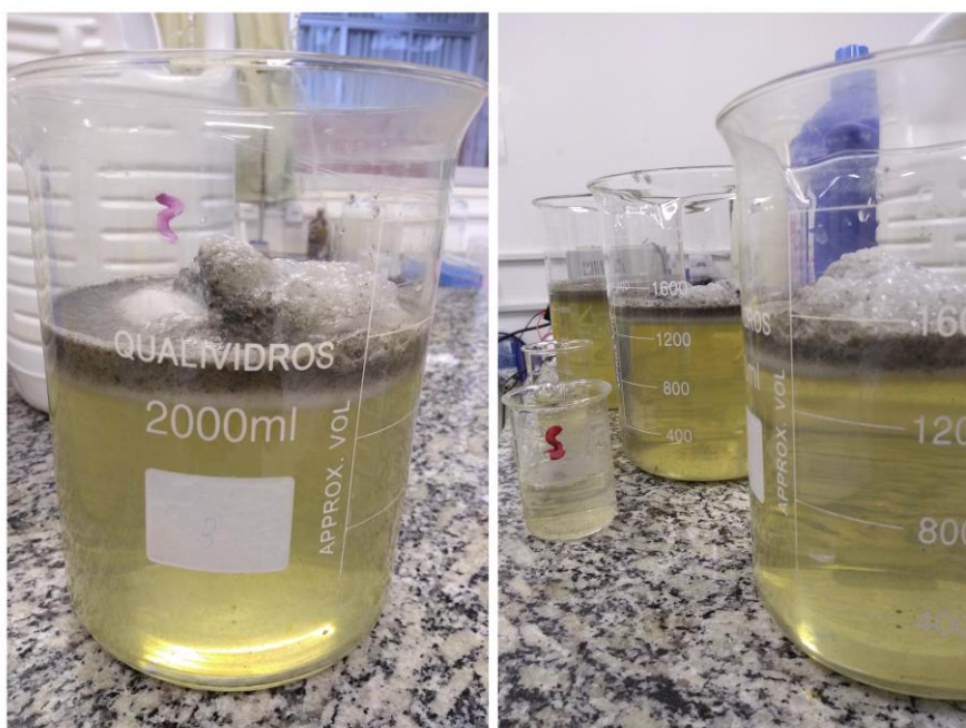
Figura 8 - Efluente após os ensaios de eletrocoagulação
