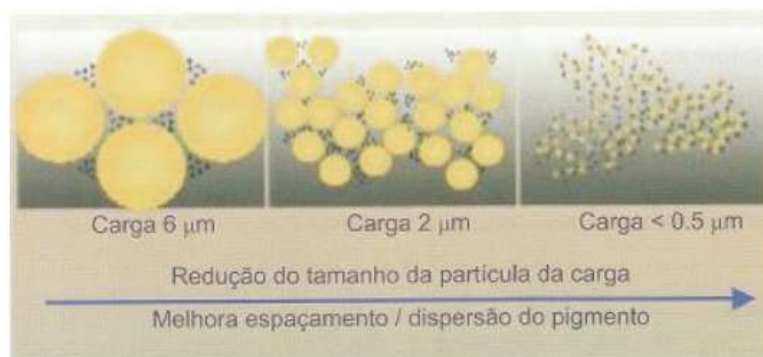
Figura 4: Otimização do espaçamento entre pigmentos de dióxido de titânio. Fonte: NOGUEIRA, 2009
