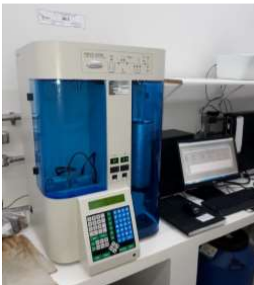
Figura 11: Equipamento da análise da área superficial e porosidade no analisador BET. Fonte: Aatoria própria (2019)
