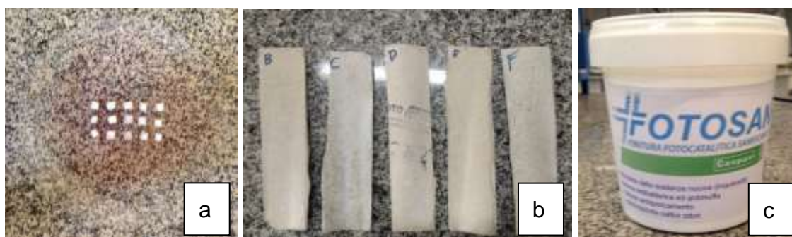
Figura 8: a) Placas de fibrocimento 5 x 5 mm. b) Placas de fibrocimento 15 x 3,5 cm. c) Tinta fotosan®. Fonte: Aatoria Própria, 2019
