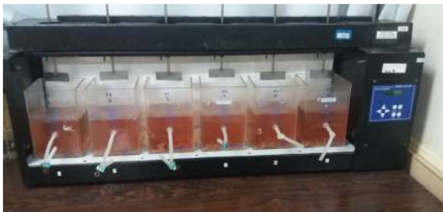
Figura 3 - Ensaio de Sedimentação no Jar-Test. Fonte: A autora (2019).
