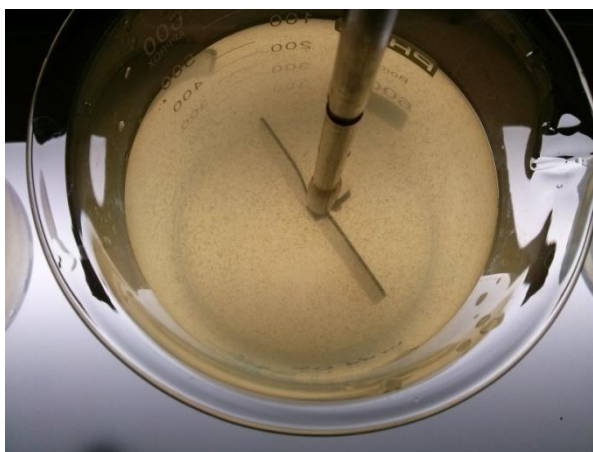
Figura 8 – Início da Coagulação com Concentração de 30ppm de NOVFLOC.
