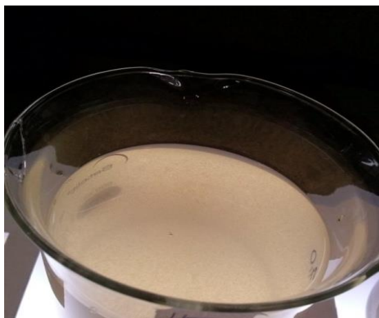
Figura 9 - Início da Coagulação com Concentração de 150 ppm de MO.
