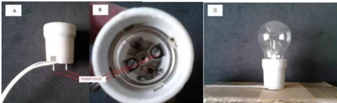
**Fotografia 3: A: Vista lateral do soquete. B: Vista superior do soquete. C: Soquete com a lâmpada instalado nas placas de papelão.**
