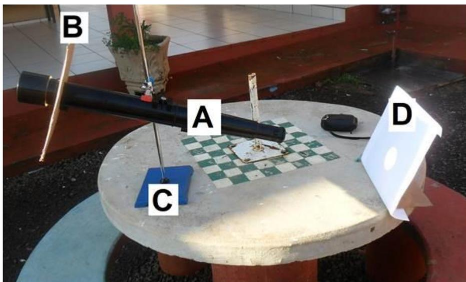
**Fotografia 1: Projetor Solar. A) Galileoscópio; B) Placa de papelão; C) Suporte universal com garra metálica; D) Folha de papel coletora de luz.**
