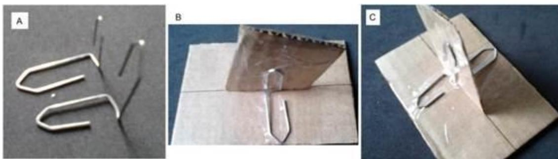
**Fotografia 6: A: Clips abertos formando um L. B: Detalhe do clips prendendo a Coluna à Base. C: Estrutura de Sustentação, formada por Coluna fixada à Base por Clips de ambos os lados.**
