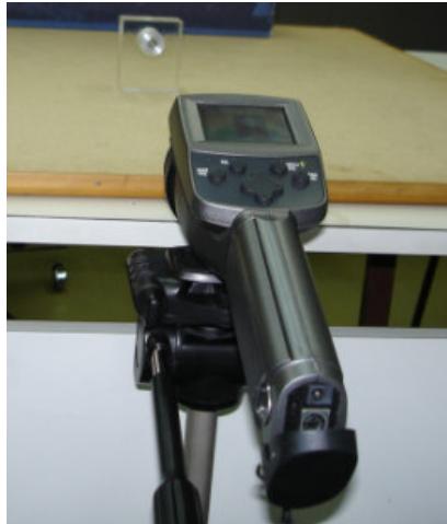
Figura 34: Câmera infravermelha ThermaCAM ® Série E Modelo 320 da FLIR.
