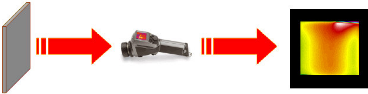
Figura 4: À esquerda, uma imagem representando a emissão de radiação de um objeto. Ao centro, câmera infravermelha para captura dessa radiação e à direita, a imagem térmica.
