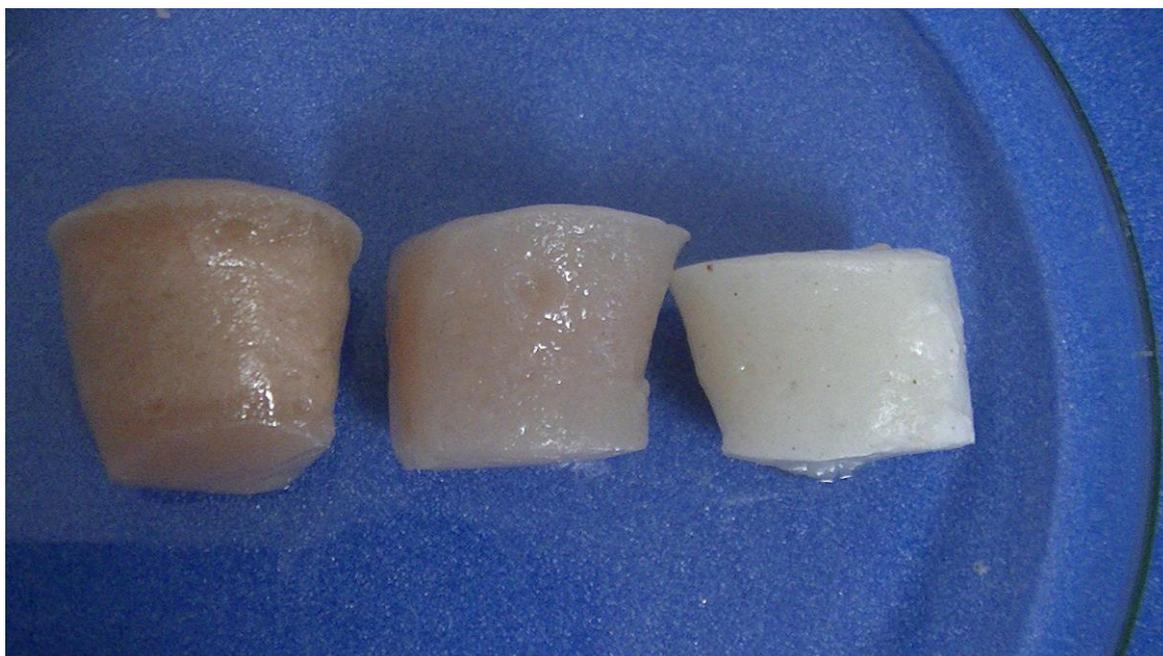
**Figura 9 - Fotografia do gel a partir do Konjac seco a 60°C, gel a partir da batata "in natura" e gel comercial (da esquerda para a direita)**
