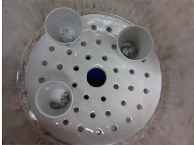
Figura 6. Amostras de hambúrguer a base de PTS no dessecador atingindo temperatura ambiente para ser pesado, após a retirada da mufla.
