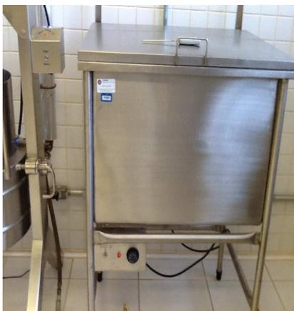
**Fotografia 5 - Tanque de pasteurização**
