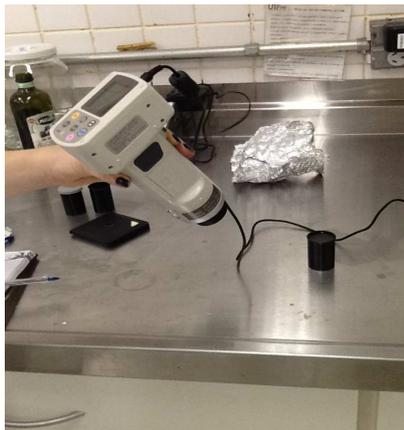
**Fotografia 13 - Aparelho de determinação de cor**
