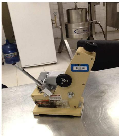
**Fotografia 14 - Refratômetro de ° Brix**
