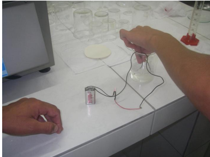
Figura 3 – Verificação da propriedade de condução elétrica das Soluções Fonte: Arquivo da autora (2011)
