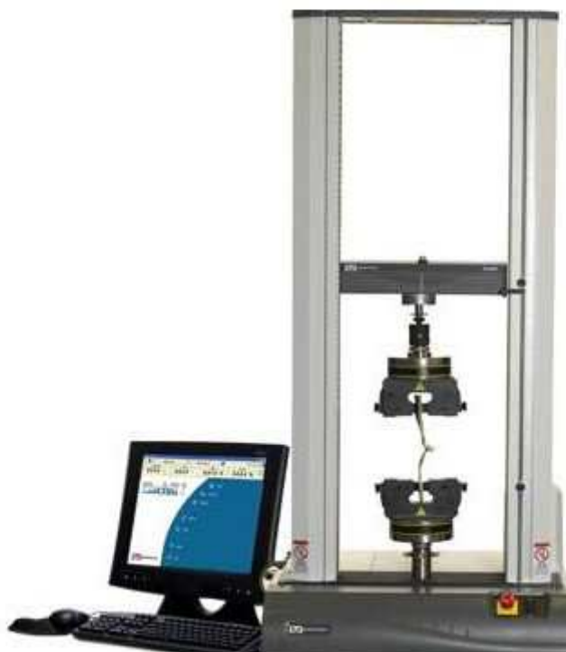
Figura 3: Máquina universal de ensaios, Modelo Instron 3360.
