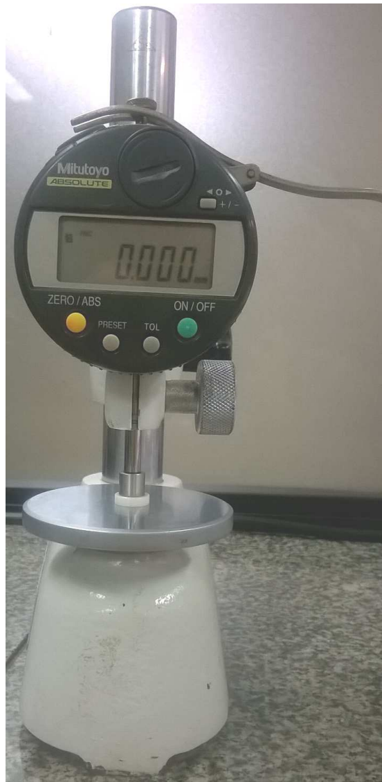
Figura 4: Relógio Comparador digital modelo ABSOLUTE ID-C, serie 546 da marca Mitutoyo
