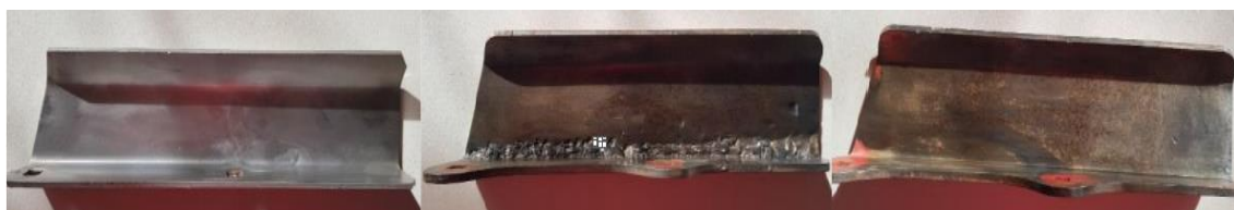
Figura 16 - Palhetas em estudo de diferentes materiais: aço inoxidável, revestida com solda e original 1020, respectivamente Fonte: adaptado de Zuffo e da Silva (2017)
