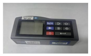
Figura 8. Rugosímetro Instrutherm RP-200. Fonte: Autoria própria.
