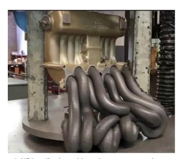
Figura 2. UFA realizada em bloco de motor automotivo.
