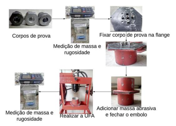
Figura 9. Fluxograma do procedimento experimental. Fonte: Autoria própria.
