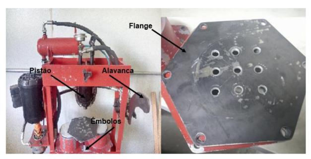
Figura 7. Máquina de usinagem por fluxo abrasivo. Fonte: Autoria própria.
