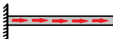
Figura 9 – Barra engastada em uma extremidade e livre na outra, submetida a um carregamento axial distribuído ao longo do comprimento.
