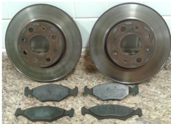
Figura 15 - Discos de freio e pastilhas usados com 42.750 Km rodados
