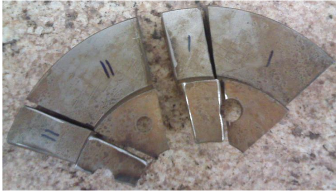
Figura 31 - Distribuição das partes retiradas de cada um sexto (disco novo) Fonte: Aatoria própria
