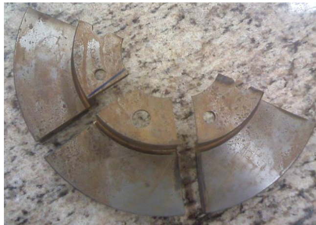
Figura 26 - Disco novo cortado em três partes iguais Fonte: Autoria própria
