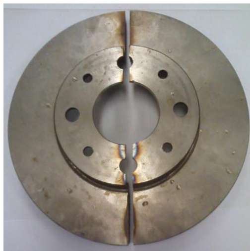
Figura 20 - Corte ao meio do disco novo Fonte: Autoria própria
