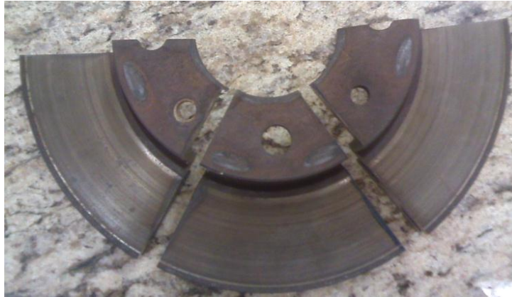
Figura 25 - Disco usado cortado em três partes iguais Fonte: Autoria própria
