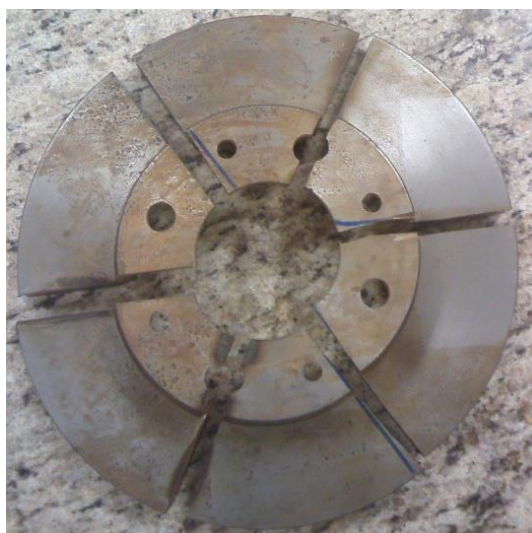
Figura 28 - Disco novo cortado em seis partes iguais Fonte: Aatoria própria
