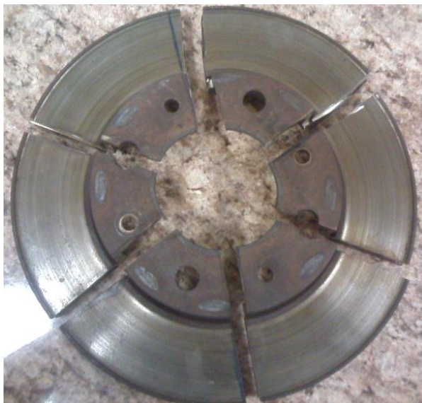
Figura 27 - Disco usado cortado em seis partes iguais Fonte: Aatoria própria
