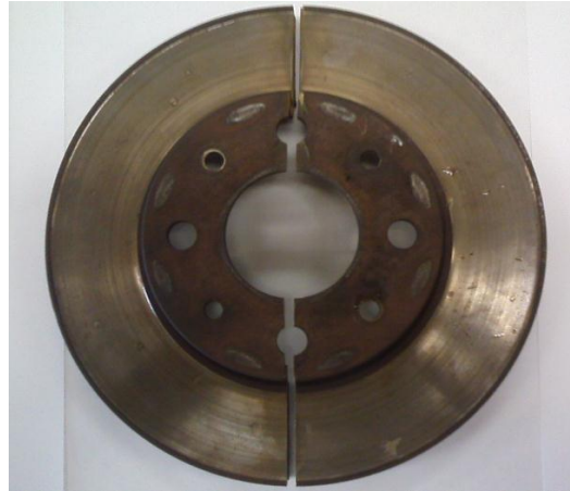
Figura 18 - Corte ao meio do disco usado Fonte: Autoria própria
