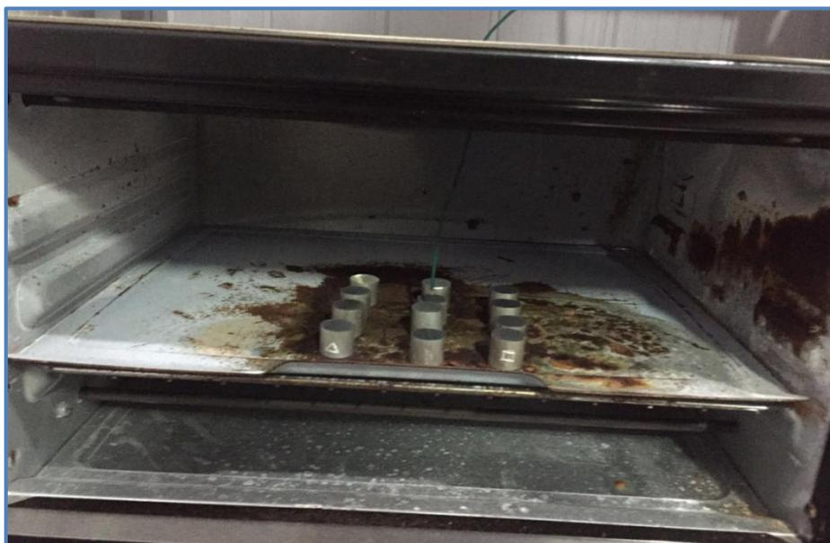
**Figura 17 - Forno utilizado para o envelhecimento das amostras.**
