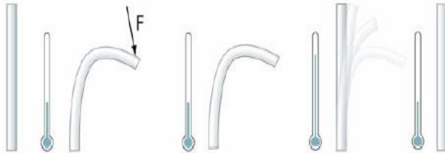
Figura 5 - Demonstração da memória de forma unidirecional. Fonte: REIS (2001)
